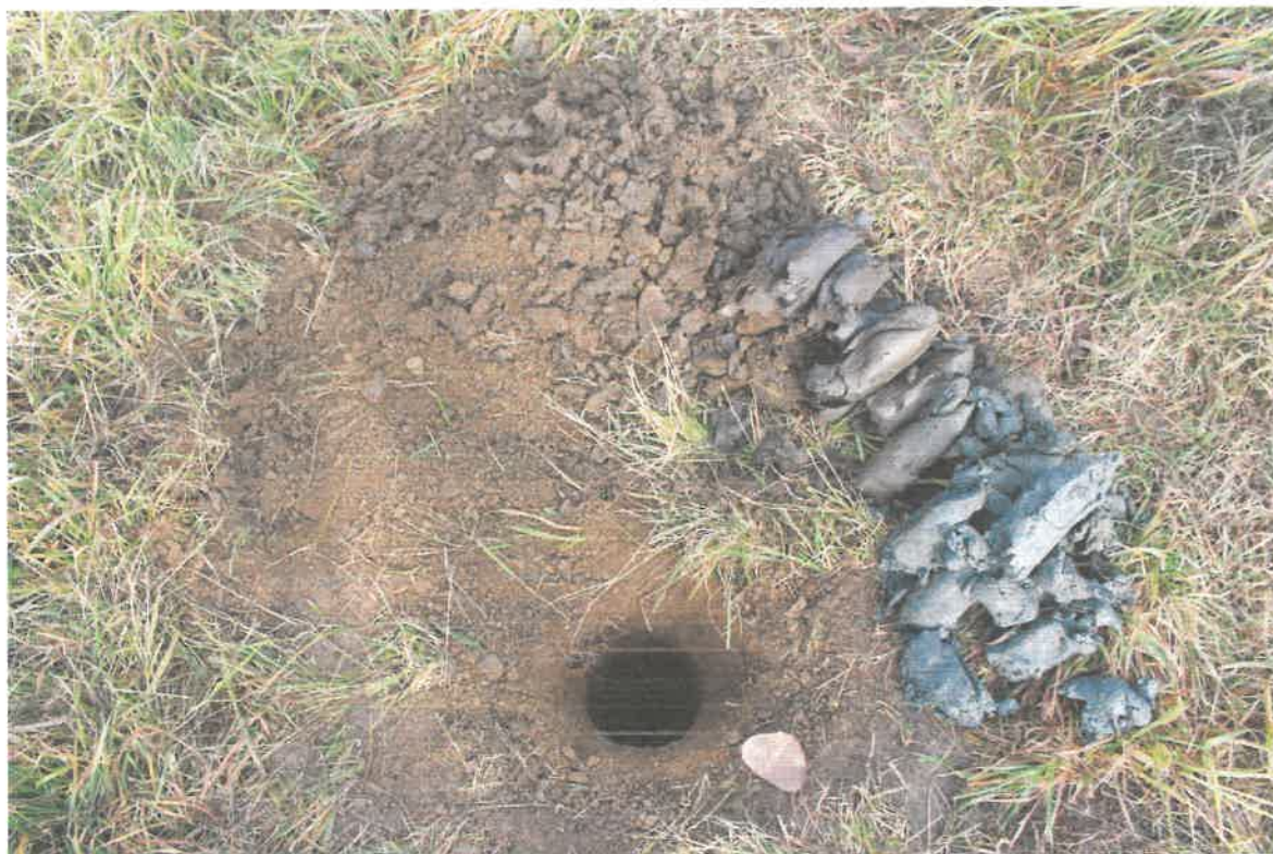
Foto 3 – succesiunea litologică interceptată în forajul geotehnic numărul 3
