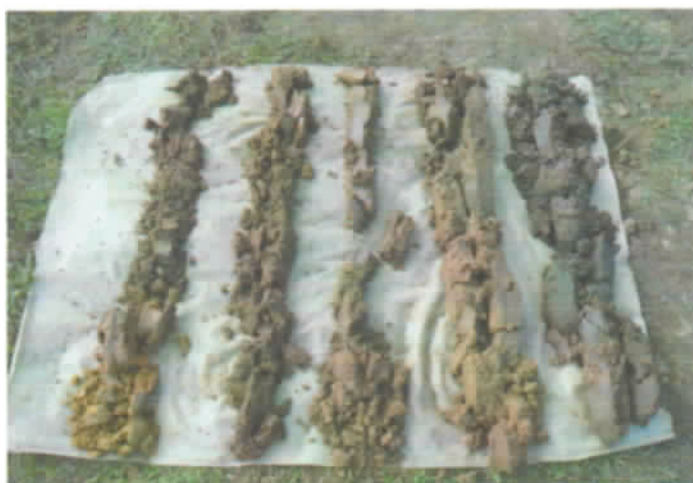
Foto.2. Litologia interceptată în forajul FG-1
